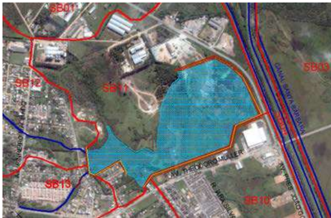
Figura 39: Proposição 1 - Reservatório na cota de coroamento 6,0 m.
