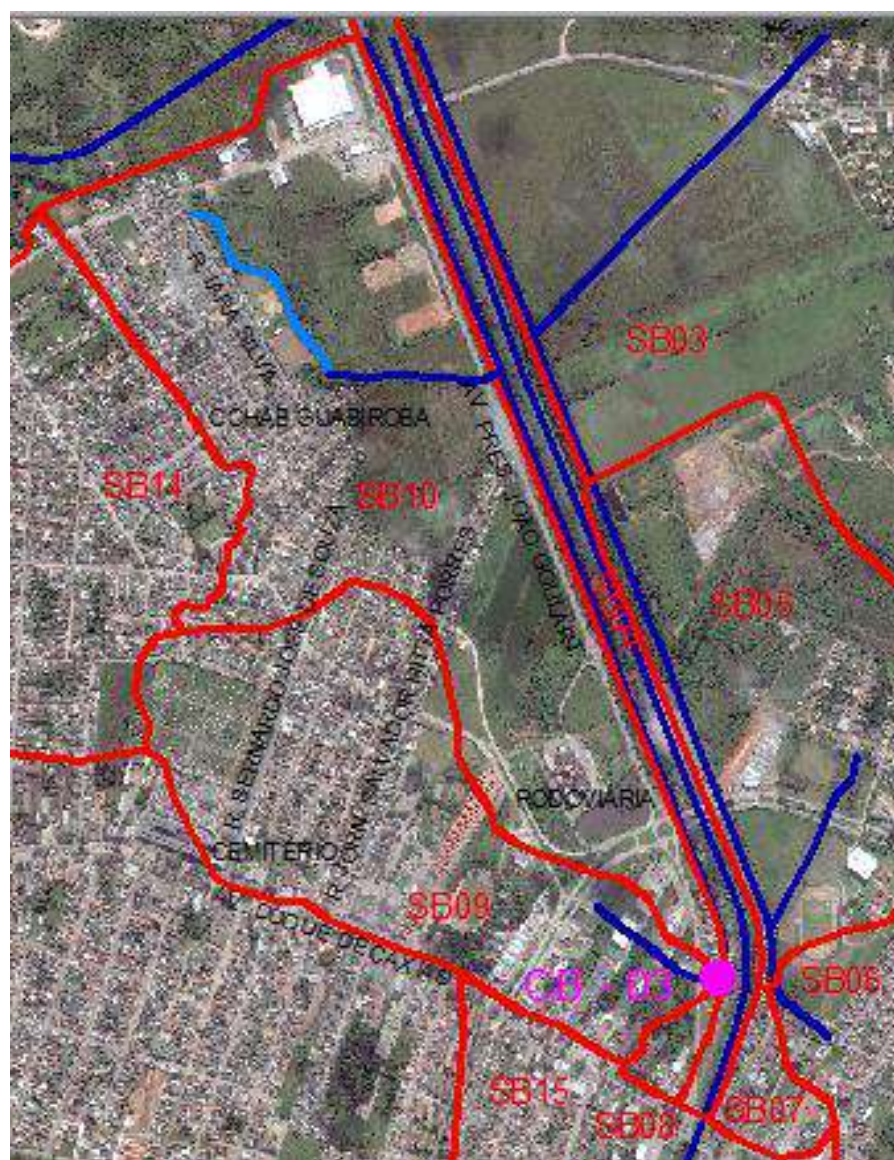
Figura 44: Casa de Bombas 03 - CB-01 e Sub-bacias Sb-08, Sb-09 e Sb-10.
