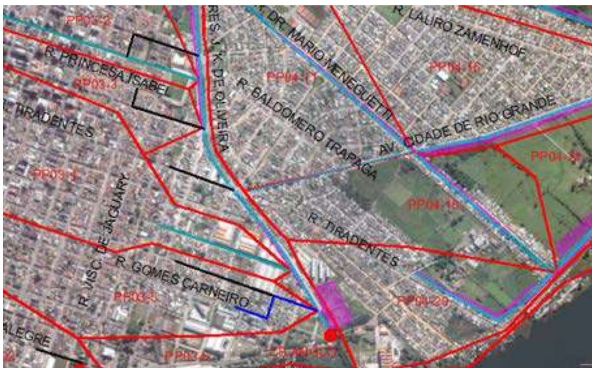
Figura 57: Proposições de Macrodrainagem para o trecho de jusante das sub-bacias PP-03 e PP-04.
