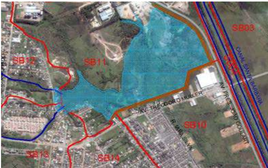
Figura 40: Proposição 2 - Reservatório na cota de coroamento 5,0 m.
